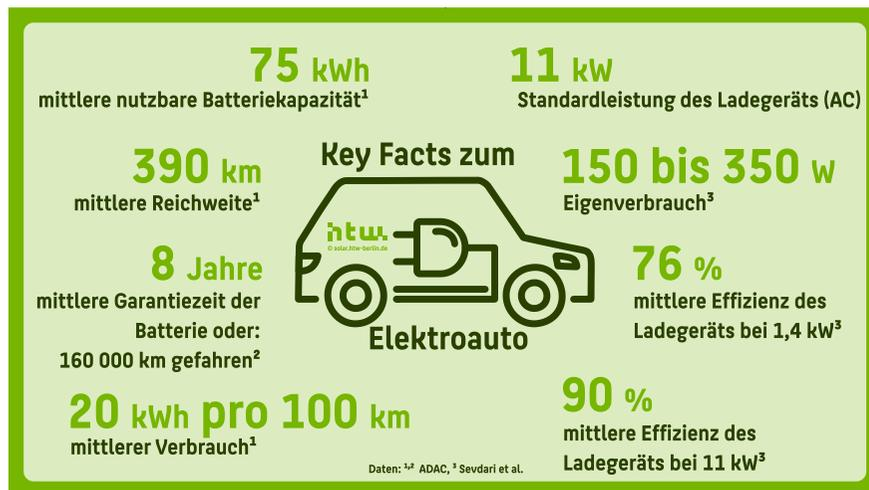
**Bild 1** Ausgewählte Kennzahlen von Elektrofahrzeugen. Daten: ADAC [1], [2] und Sevdari et al. [3].
