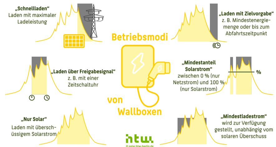
**Bild 27** Typische Betriebsmodi von intelligenten Wallboxen, die mit solarem Überschuss Elektrofahrzeuge laden können.
