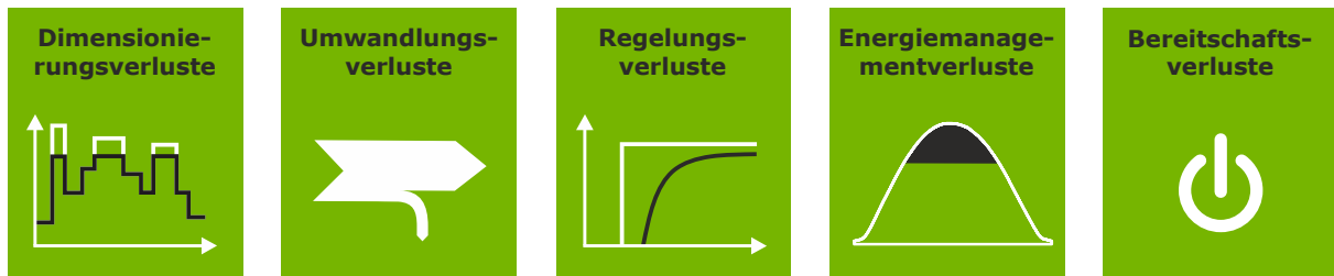
Bild 2: Klassifizierung der Energieverlustmechanismen in netzgekoppelten PV-Batteriesystemen.
