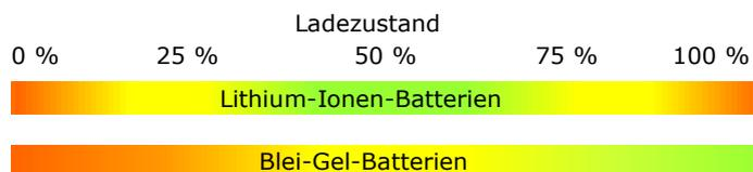
**Bild 2.6** Einfluss des Ladezustandsbereichs auf die Alterung von Lithium-Ionen-Batterien nach [Bir12] und Blei-Gel-Batterien (rot: hohe Alterung, grün: geringe Alterung)
