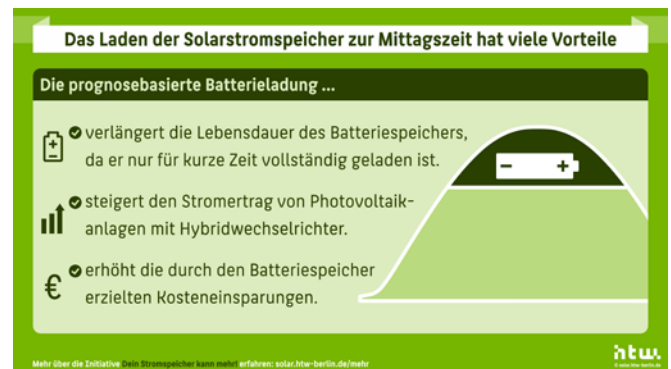
Abb 3 – Wenn der Stromspeicher nicht vormittags, sondern in den Mittags- und Nachmittagsstunden lädt, hat das viele Vorteile • Grafik: HTW-Berlin
