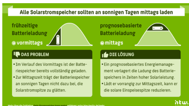
Abb 1 — Intelligente Heimspeicher fangen die Solarstromspitzen ab, noch bevor sie in das Netz gelangen. Das macht im Stromnetz Platz für weitere neue Photovoltaikanlagen • Grafik: HTW Berlin
